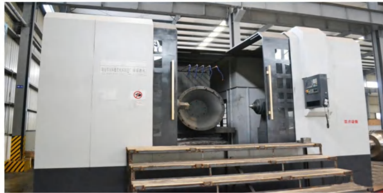
精密数控球球面磨床 [有效加工尺寸：36寸-56寸]
