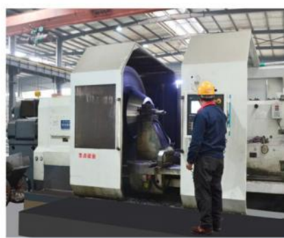
CK61200数控重型卧式车床 [床身上最大回转直径:2000mm] [最大车削长度:6000mm]
